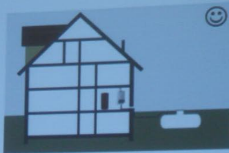
Chaudière installée au rez-de-chaussée ou dans les combles avec entrée de la conduite en souterrain
